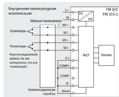
Правый фронтальный соединитель модуля FM 355S
