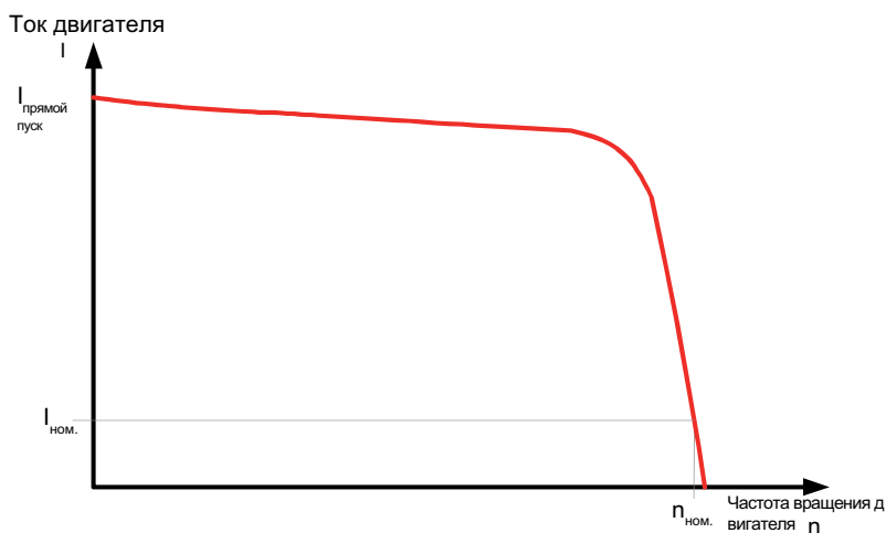
Изображение 3-1 Типовая характеристика пускового тока асинхронного двигателя трехфазного тока
