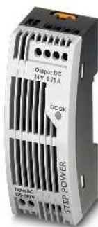
Источник питания, 1 AC, 24 В DC, 0,75 А плоская конструкция, NEC, класс 2
