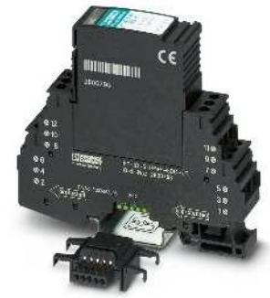
5 проводников, с общим опорным потенциалом, подключение 9/10, заземление через газовый разрядник
