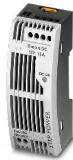
Источник питания, 1 AC, 12 В DC, 1,5 А плоская конструкция, NEC, класс 2
